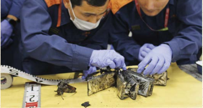
なぜリチウムイオン電池から出火したのか、分解し鑑識見分をしている様子。
