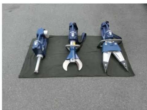
大型油圧資器材は、車両を破壊することができます。
