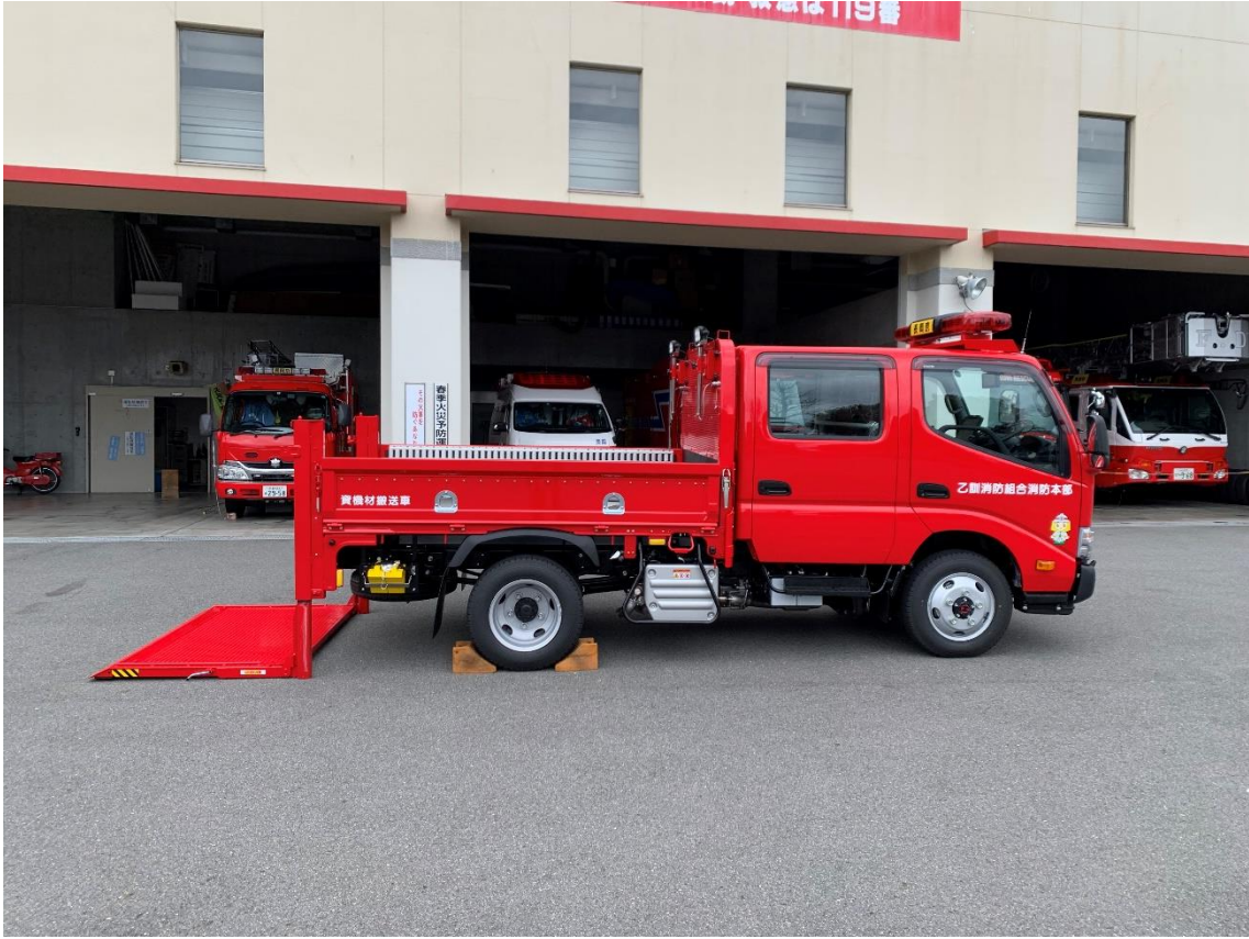
電動油圧昇降装置が作動している写真です。
