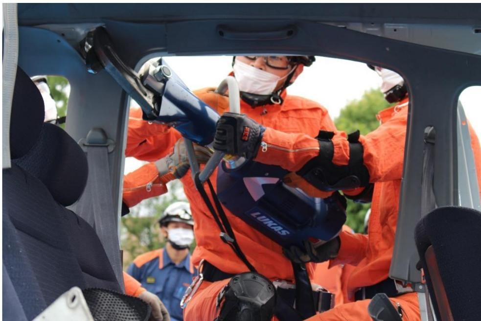
大型油圧救助器具（カッター）での切断状況。長岡京署の大型油圧救助器具はバッテリー駆動となっており、油圧ホース等を接続する必要がないため、迅速に活動を開始することができます。
