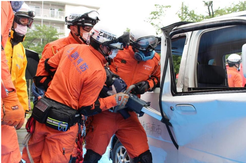
大型油圧救助器具（スプレッダー）を使用して、開放不能となっている扉を押し拡げて開放していきます。
