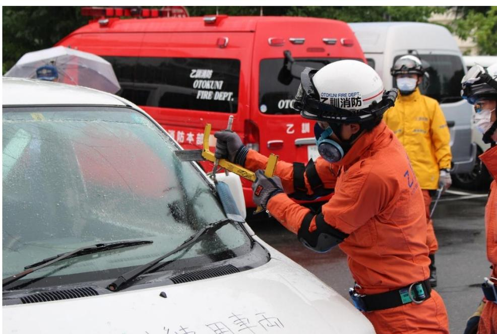
フロントガラスは合わせガラスのため、専用の切断器具（グラスマスター）を使用して切断します。
