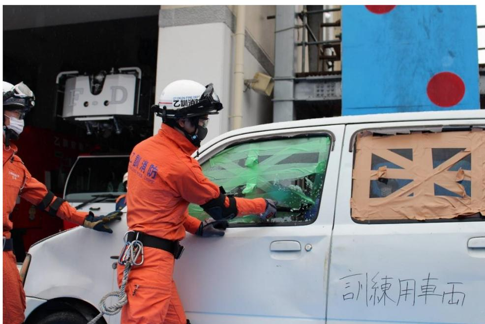
強化ガラスは飛散防止のため、テープを使用し飛散防止処置を実施し破壊します。
